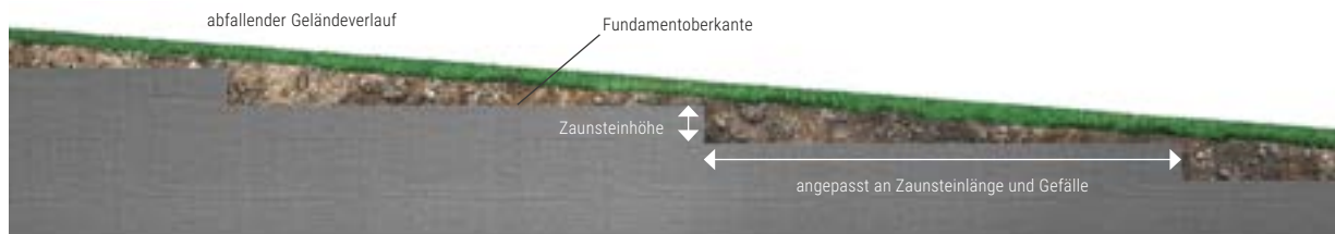
Abbildung 8: Abgestuftes Fundament bei einem Gefälle
