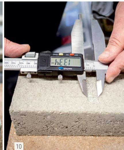
**8 + 9 + 10** Bestimmung des Abriebwiderstands. Die Oberseite des Steins wird mit einem Schlefmittel unter genormten Bedingungen abgeschliffen. Die Abriebstelle angezeichnet und an drei Stellen gemessen.
